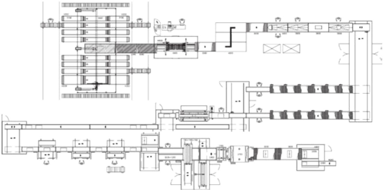
Sistema flexible para la fabricación de mobiliario de interior por encargo para un mueblista.
