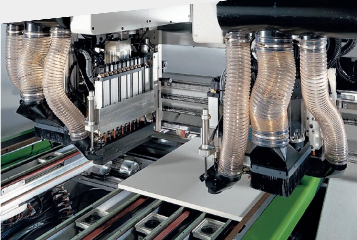
La presencia de **dos pares de cabezales operadores** montados en dos carros móviles independientes hace posible la ejecución de las operaciones de perforación más complejas en tiempos sumamente reducidos, incluso teniendo que elaborar piezas distintas entre sí.
